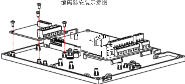
编码器接线示意图
